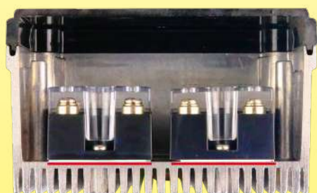
Installationsbeispiel für Halbleiterrelais in einem Utimheat Aluminium-gehäuse (Wärmeleitpaste in rot)
